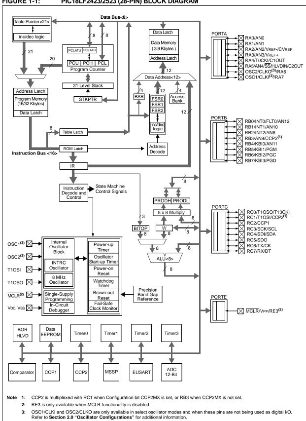
FIGURE 1-1: **PIC18LF2423/2523 (28-PIN) BLOCK DIAGRAM**
