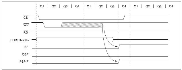
FIGURE 10-4: PARALLEL SLAVE PORT READ WAVEFORMS
