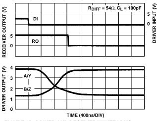
FIGURE 15. DRIVER AND RECEIVER WAVEFORMS, HIGH TO LOW (ISL8483E)
