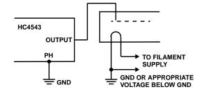
FIGURE 7. CONNECTION TO GAS-DISCHARGE DISPLAY READOUT
