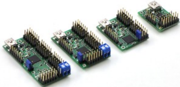
Maestro family of USB servo controllers: Mini 24, Mini 18, Mini 12, and Micro 6.
