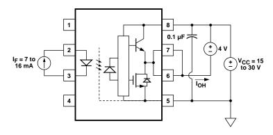
Figure 17.  $\rm I_{OH}$  Test Circuit.
