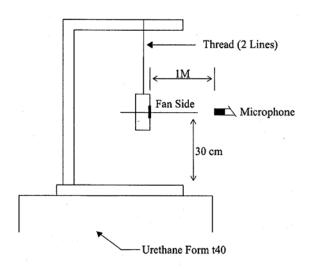
1 METER FROM MICROPHONE TO FAN INTAKE
