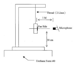
1 METER FROM MICROPHONE TO FAN INTAKE
